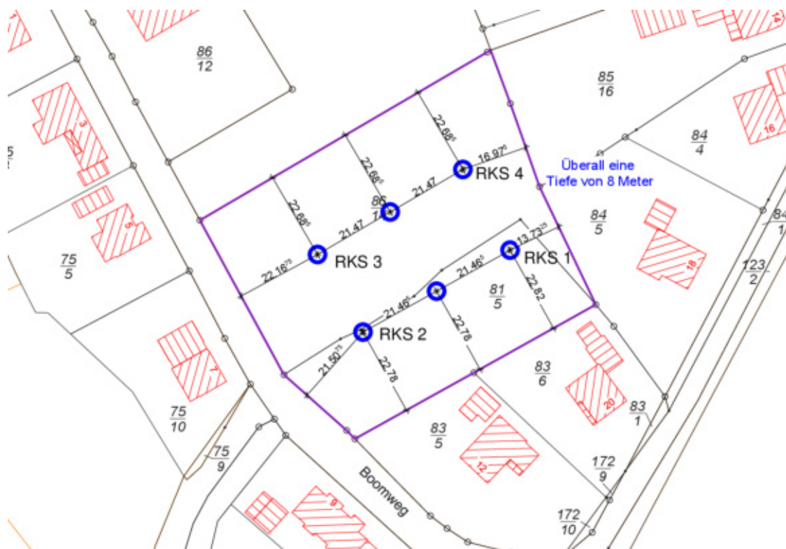
Abbildung 2: Lageplan mit Bohrungen RKS 1 – RKS 4
