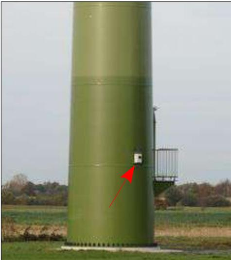
Abbildung 3: Batcorder in der Waldbox-erweiterung am Mastfuß installiert
