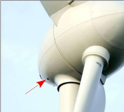
Abbildung 2: Einbauort des Mikrofons am Beispiel der E-53
